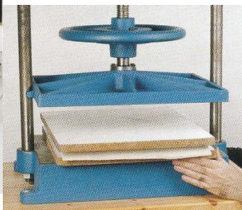
Encrage de la matrice en bois et passage sous la presse
